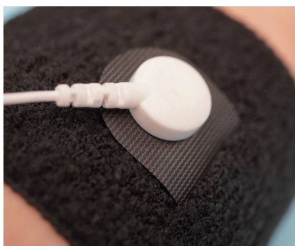
●汎用スナップボタンを用いた端子接続イメージ
